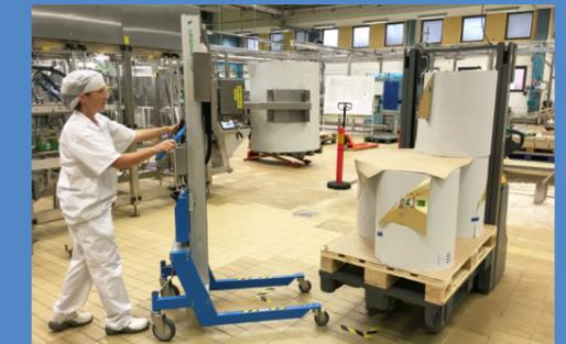
Squeeze&Turn ist eine gern verwendete Ausstattung bei der Handhabung von großen Rollen in der Produktion. An einen Lift&Drive montiert ist sie dem Bediener die Kraft und Kontrolle für sicheres und effizientes Arbeiten.
