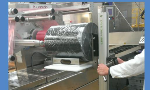
In einer Druckerei werden oft relativ kleine, dafür aber schwere Rollen verschiedenster Materialien gehandhabt. Bei solchen Einsatzgebieten sind sie mit einem Lift&Drive mit Plattform und V-Block bereits einfach und perfekt ausgestattet. Dazu agieren Sie wendig auf kleinstem Raum.
